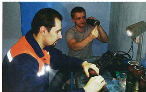
На фото: дефектоскописты Забелин Д.А. и Шагаев И.В. за анализом стыков труб
